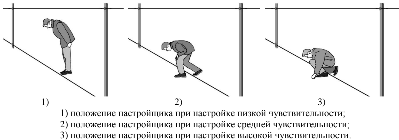
Рисунок 2.11 Способы имитаций преодоления 30 при приземном варианте установки.
